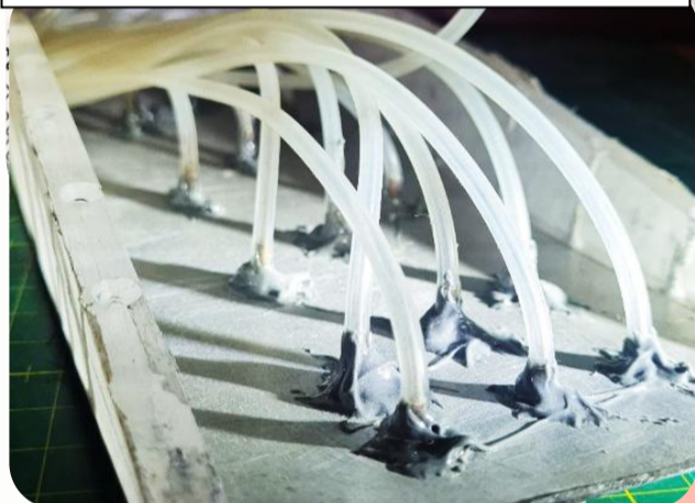
Arriba, perfil alar posicionado. Abajo, mangueras conductoras del fluido hacia sensores de presión.
