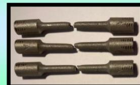
Fig 9. Fractura probetas tracción.
