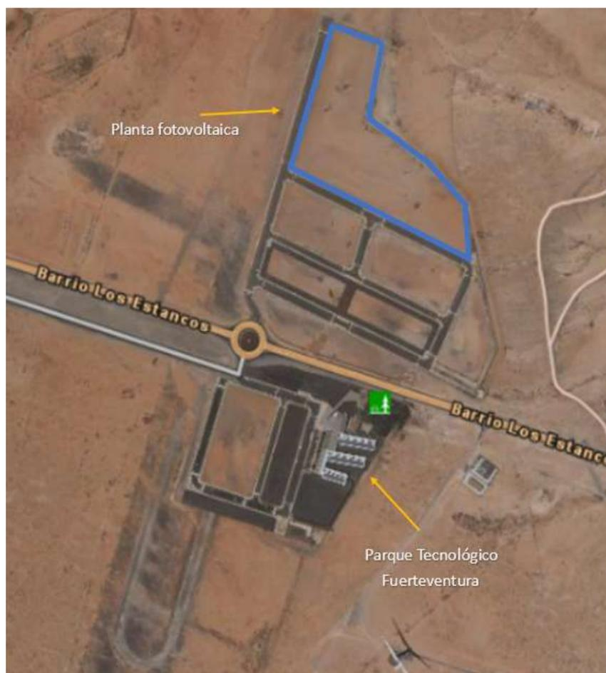
La planta fotovoltaica cuenta con 5544 paneles solares de 550W cada uno. Se han agrupado en 22 paneles solares que irán conectados a los 3 String Station, instalados en la planta. Cada estación cuenta con 3 inversores, un centro de transformación y la celda de media tensión dado así una potencia de 1 MW.
