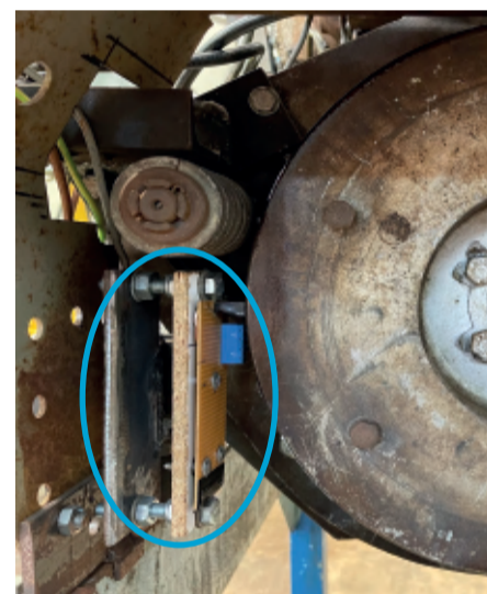
Sensor óptico con función de tacómetro
