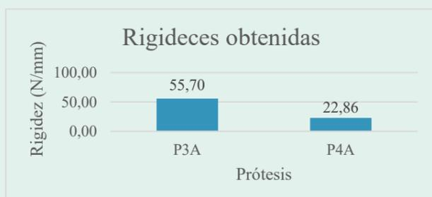
En cuanto al análisis 3, se ensambló la prótesis en un semianillo, se aplicó un desplazamiento de 25 mm en el extremo del implante, el extremo superior del hueso se empotró y con ello se vio que esfuerzos se producen en el mismo según la rigidez obtenida. En base a los ensayos 2 y 3, se seleccionó P4A para el último análisis.
