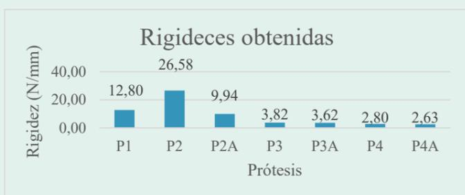
En el análisis 2 se simuló un ensayo de flexión a tres puntos. Por ello se empotraron los extremos y se aplicó en un área en el medio de la prótesis un desplazamiento de 25 mm. Se obtuvo:
