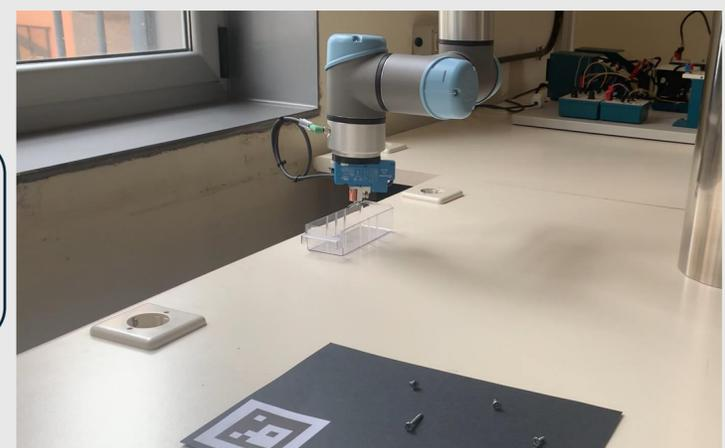
Figura 4: El robot deposita el tornillo defectuoso en una caja
