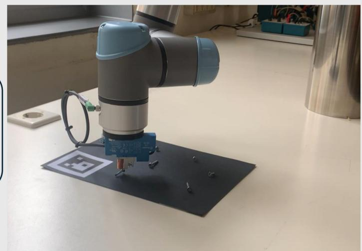
Figura 3: El robot toma un tornillo defectuoso
