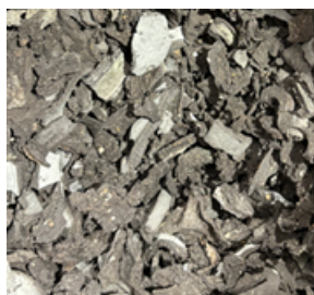
Figura 1. Lodo de depuradora seco.
