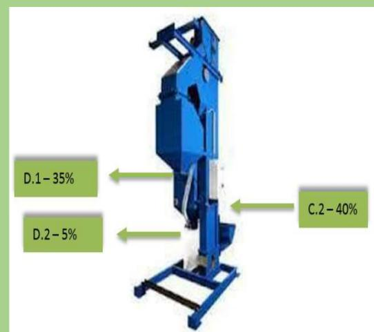
D.1. Salida de granalla entre 1 y 3 mm recuperada que vuelve a ser utilizada en procesos de chorreado.
