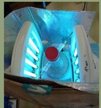
Fig. 2. Fotorreactor durante el ensayo de producción de  $H_2$ .
