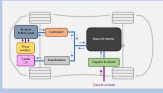
La corriente se toma de la red en alterna a través del enchufe del cargador, yendo directamente al cargador de abordo. Éste transforma la corriente en continua, ajustándola en voltaje e intensidad para su posterior almacenamiento en el banco de baterías, influyendo en la autonomía del vehículo...
