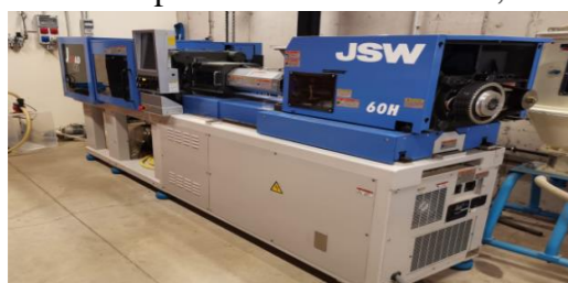
Inyectora de plástico eléctrica JSW 55T AD 60H
