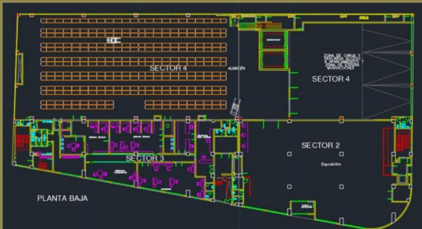
La nave industrial cuenta con una Planta Baja, en la que se realizan las funciones de exposición, almacenamiento, oficinas y zona de carga y descarga. La parte de la nave destinada a almacenamiento tiene una altura de 7 m y la destinada a oficinas de 4 m.
