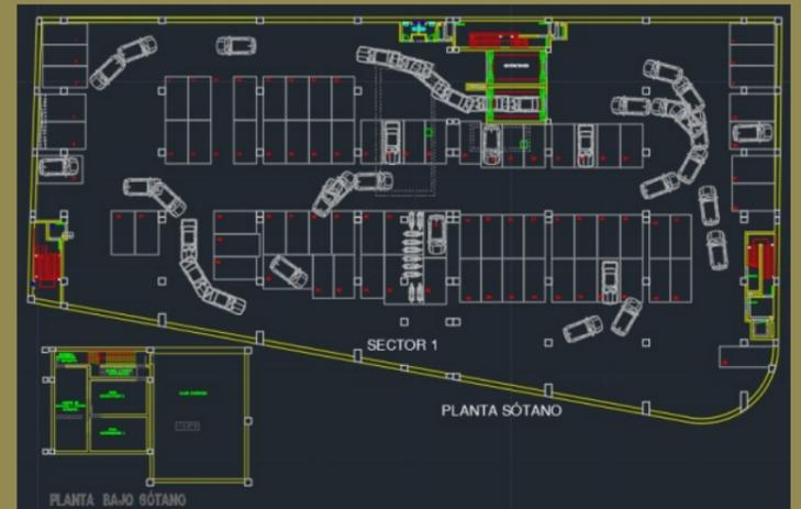
La nave industrial contiene una planta sótano (-1) destinada a aparcamiento de 80 plazas, con una altura de 5 m y con acceso mediante montacoches. Y contiene una sala de máquinas y los fosos montacoches en la planta bajo sótano (-2).
