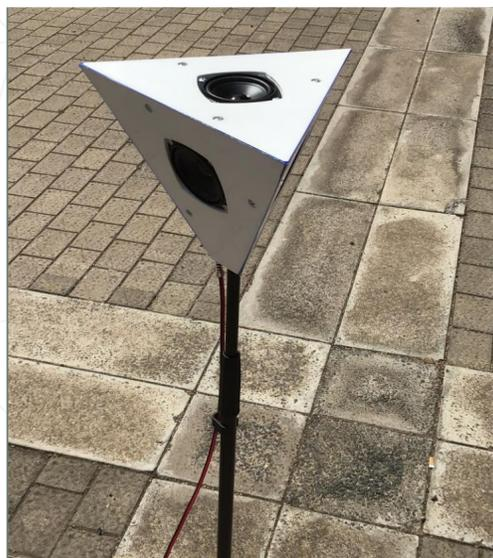
Tras la realización del ensayo basado en la norma UNE – 3382-1:2010, se obtienen los siguientes resultados de desviación de directividad comparando con el rango impuesto por dicha norma, y con la referencia en la que se basa la elección de la fuente sonora con geometría tetraédrica.
