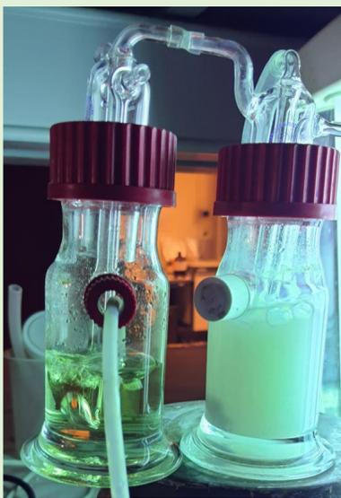
**Figura 1.** Trampa de yoduro para la detección de cloro
