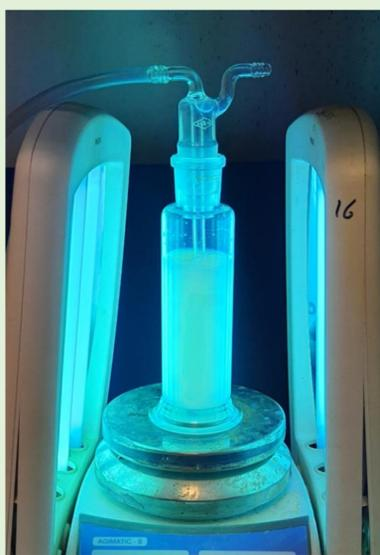
**Figura 2.** Proceso de fotodeposición
