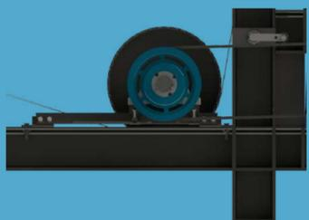
El mecanismo que conforma el textil no tejido está formado por una biela, una excéntrica, cuatro rodamientos lineales, dos placas y 2.160 agujas.
