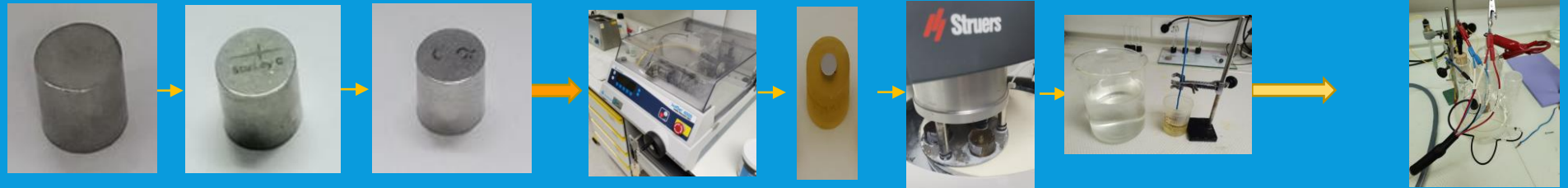
Corte Empastillado Pulido y debastado Ataque químico
